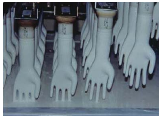
Formes de gant plongées dans la solution liquide.
