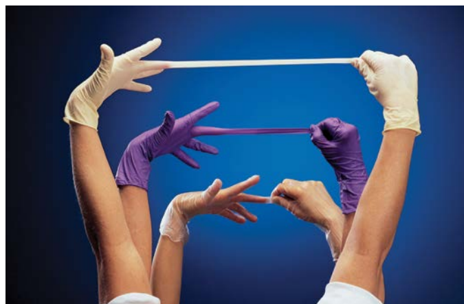
Trois types de matériau de base des gants (de haut en bas) : latex de caoutchouc naturel (LCN), acrylonitrile-butadiène (nitrile) et polychlorure de vinyle (vinyle, PVC).
