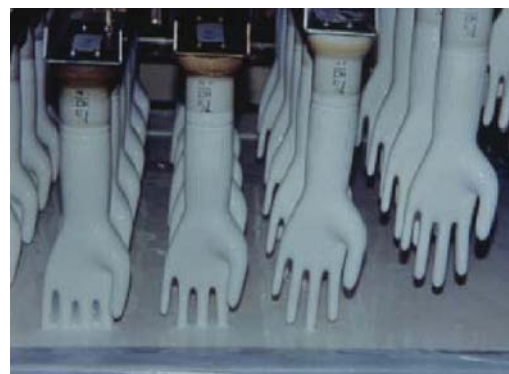
Handschoenmallen worden in een vloeibare handschoenoplossing gedompeld.
